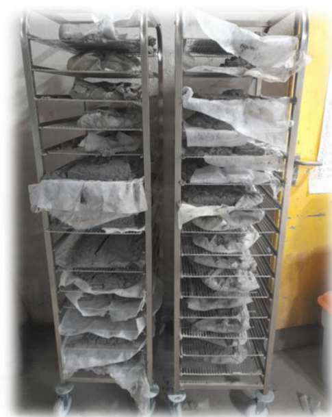
Boues en cours de séchage
